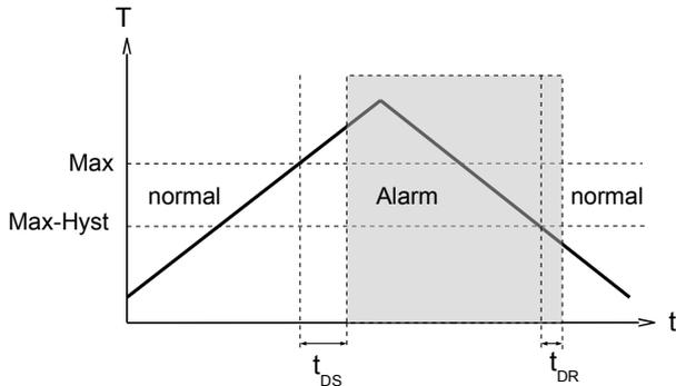
Im Normalzustand ist die integrierte LED an, im Alarmzustand aus, was dem Zustand bei fehlender Versorgungsspannung entspricht.
