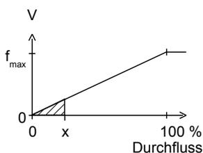
f<sub>max</sub> wählbar im Bereich bis zu 2000 Hz
