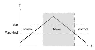
Das Wechseln in den Alarmzustand wird durch die integrierte rote LED und eine Klarschriftmeldung im Display angezeigt. Die Schaltausgänge sind im Normalzustand auf Versorgungsspan-
