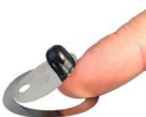
Die integrierte Auswertelektronik stellt einen elektronischen Schaltausgang (Push-Pull) mit einstellbarer Charakteristik (Minimum / Maximum) und Hysteresen zur Verfügung, der bei Über- oder Unterschreiten eines einstellbaren Grenzwertes anspricht. Der Schaltwert kann auf Wunsch über "Teach-In" bei jeweils anstehender Strömung eingestellt werden.
