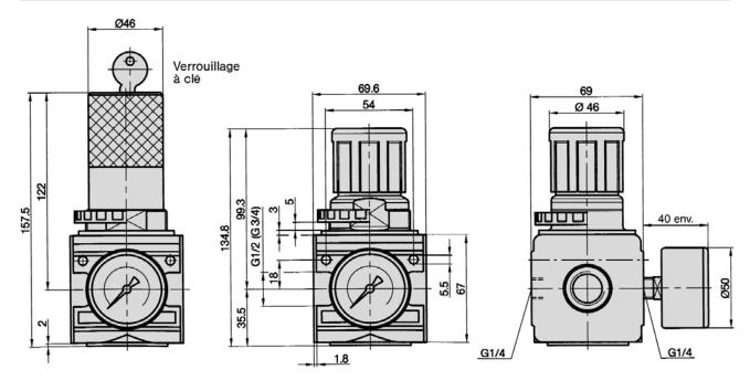
Les corps principaux possèdent deux orifices G 1/4 pour le raccordement d'un manomètre. L'orifice non utilisé est obturé par un bouchon fileté (scellé). Le sens d'écoulement de l'appareil (position de montage) peut être inversé en enlevant le bouchon et en y vissant le manomètre. Le deuxième orifice rendu libre doit alors être obturé en enfonçant et scellant le bouchon fileté.
